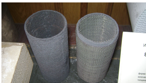
Рис. 11. Внешний вид войлочного и армированного фильтра.
