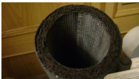
Рис. 10. Внешний вид торцевой части гематитного фильтра.
